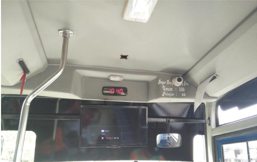
**Gambar 4.7.** CCTV sebagai alat pemantau jarak jauh dari pusat
