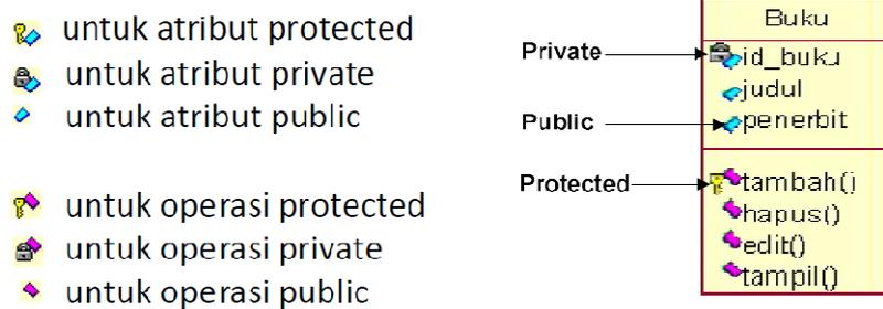
Gambar 2. 19 *Visibility* untuk Atribut dan Operasi *Class Diagram*
